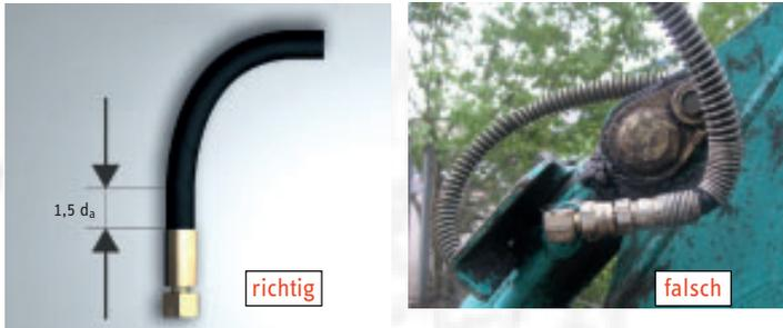
**Abbildung 8:** richtig - Gerader Abschnitt mit  $1,5 d_a$  vor Biegung
